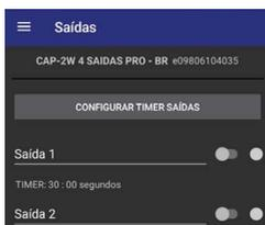
5 - A saída liga e o tempo começa a contar de forma regressiva. Ao término da contagem, a saída desliga automaticamente. Para desligar o TIMER entre em CONFIGURAR TIMER SAIDA e desative o ícone da respectiva saída.
