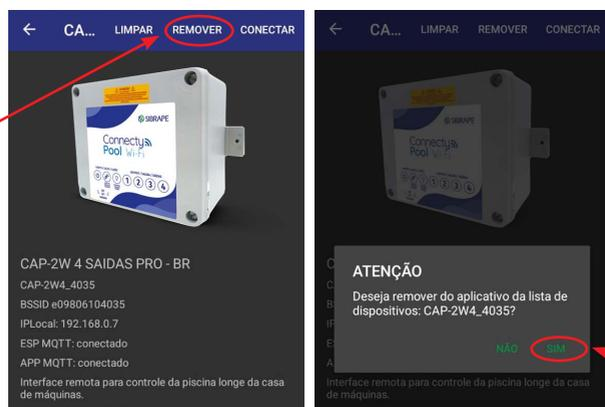
**⚠ Importante:** Ao executar este passo, o equipamento automaticamente sairá da rede e será apagado de todos os aparelhos (celulares, tablets, ...) na qual estava configurado.
