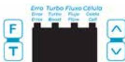
O Gerador de Cloro trabalha com dois tipos de indicação, a indicação por LEDs e a indicação alfanumérica;
