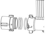
Caso 2 - Conexão do adaptador com painel: Lado Macho vai com 2 anéis externos Lado Fêmea vai com 1 anel interno.
