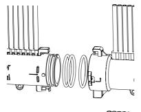
Caso 1 - Conexão de painel com painel: Lado Macho vai com anéis externos. Lado Fêmea vai com 1 anel interno.
