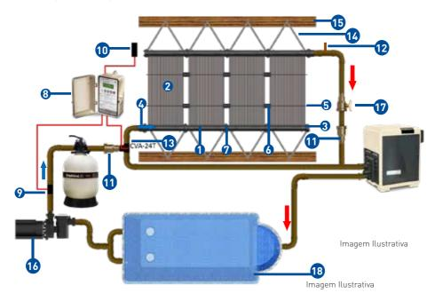
Devido à pressão negativa no momento da drenagem e retorno da água, é imprescindível que sejam instaladas a válvula de quebra vácuo (item 12) e a válvula bypass (item 17).
