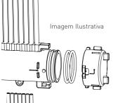
Caso 3 - Conexão do painel com tampa de fechamento: Lado Macho vai com 2 anéis externos.
